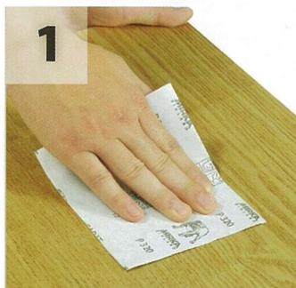
Permukaan kayu yang akan dicat harus diampelas terlebih dahulu supaya halus. Serbuk kayu, minyak, gemuk, minyak oli dan kotoran lain harus dihilangkan dengan cara dilap, dihembus udara atau dibersihkan dengan solvent tertentu. Pastikan permukaan kering dan bersih sebelum pengaplikasian.
